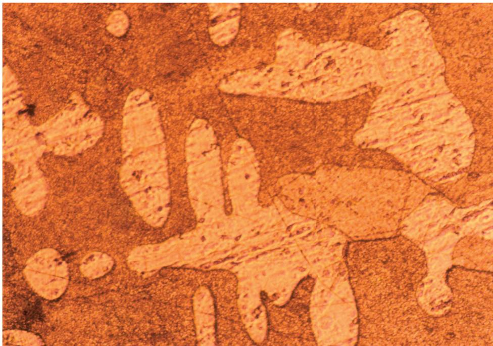
Ryc. 3. Mikrofotografia barwna miedzi anodowej (po procesie ogniowej rafinacji) o zawartości około 0,2% tlenu. Widoczne krystality miedzi. Obserwacja przy powiększeniu 500x.
